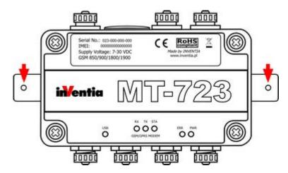
Nie należy narażać obudowy na naprężenia bądź drgania mechaniczne, które mogą doprowadzić do jej rozhermetyzowania i w konsekwencji uszkodzenia urządzenia. Do not expose the enclosure to tension or mechanical vibrations, which may lead to the dehermetization and as consequence to module damage.
