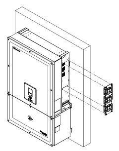
Figure 5-6 Removing the fan
